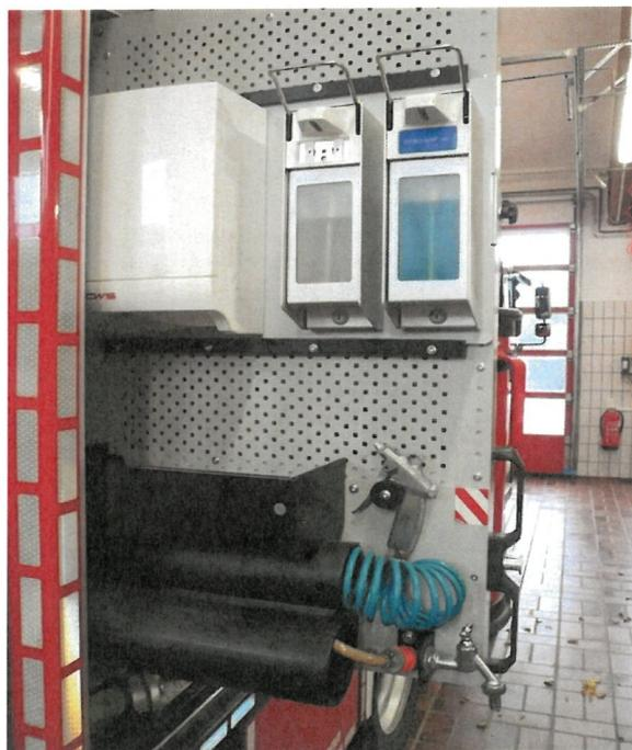
Hygienebord mit Druckluftanschluss, Wasseranschlauss, Seife, Desinfektionsmittel sowie Papierhandtücher im HLF 20 Wassenberg und Birgelen sowie im LF 20 KatS Effeld.
