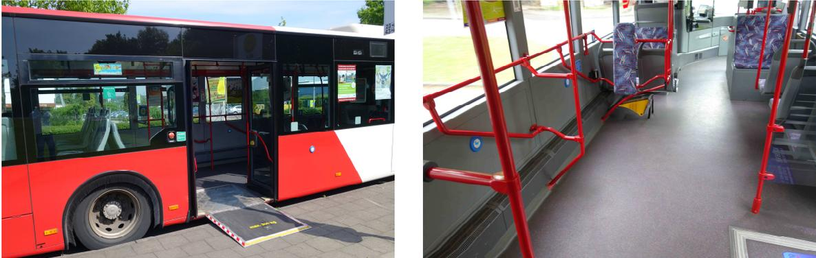
Abb. 119: Barrierefreie Elemente in ÖV-Fahrzeugen
